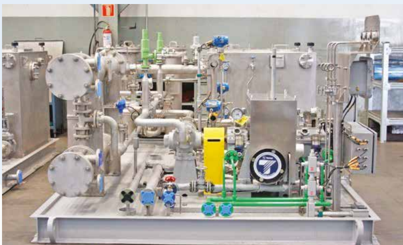
Unidade de Lubrificação Forçada (UFL)
